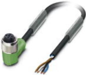
Sensor-/Aktor-Kabel, 4-polig, PUR halogenfrei, schwarzgrau RAL 7021, freies Leitungsende, auf Buchse gewinkelt M12, A-kodiert, Kabellänge: 10 m
