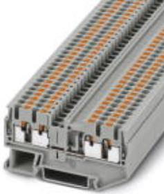
Durchgangsklemme, Anschlussart: Push-in-Anschluss, Querschnitt: 0,14 mm<sup>2</sup> - 4 mm<sup>2</sup>, AWG: 26 - 12, Breite: 5,2 mm, Höhe: 35,3 mm, Farbe: grau, Montageart: NS 35/7,5, NS 35/15
