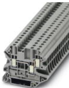
Durchgangsklemme, Anschlussart: Schraubanschluss, Querschnitt: 0,14 mm 2 - 6 mm 2 , AWG: 26 - 10, Breite: 6,2 mm, Farbe: grau, Montageart: NS 35/7,5, NS 35/15
