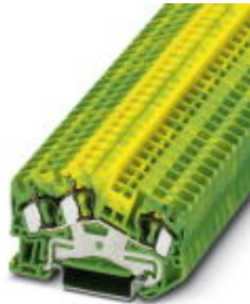
Durchgangsklemme, Anschlussart: Zugfederanschluss, Querschnitt: 0,08 mm 2 - 6 mm 2 , AWG: 28 - 10, Breite: 6,2 mm, Farbe: grün-gelb, Montageart: NS 35/7,5, NS 35/15
